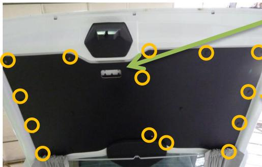
Die Blende für den Griff mit einem Keil ab hebeln.
