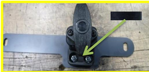
Wie abgebildet den Halter 281060248130 auf den Blech setzen und mit den Scheiben 649006 und den Muttern 648022 festschrauben. Dann den Drehverschluss 515320 mit den Schrauben 653217 festschrauben. Zum Schluss mit filz die Muttern abdecken.
