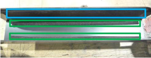
Filz band Links und Rechts an den Aufnahmen wie abgebildet ankleben. Hochkant das Dicke Filz band und unten in den Ecken
