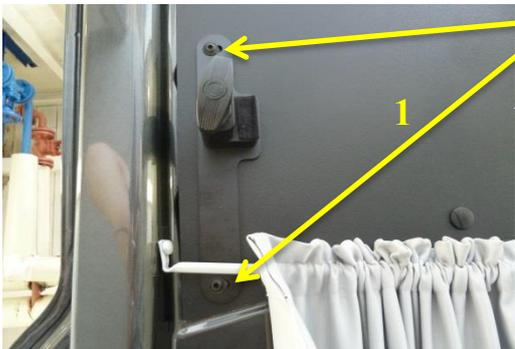
Halter 1 mit Schraube 637263 festgeschraubt werden. Die Schrauben in den Langlöchern sollten möglichst mittig sein.
