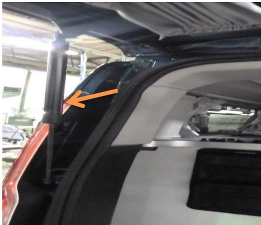
Die Originalen Gasdruckdämpfer Links und Rechts an der Heckklappe gegen die Gasdruckdämpfer 524004 mit 935Nm austauschen
