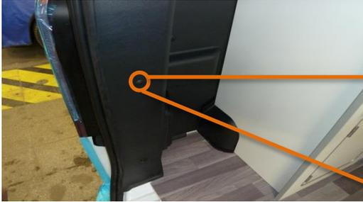
Den Clips aus der Verkleidung entfernen
